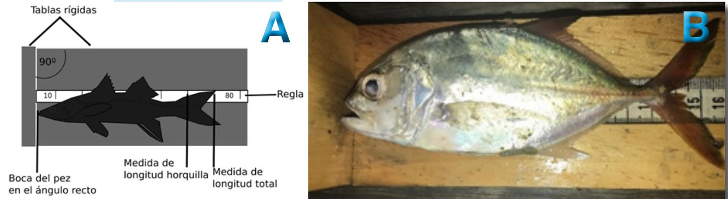
Figura 4. Diagrama (a) y fotografía (b) de medición de longitud empleando el ictiómetro. El valor se da redondeado al menor centímetro, debido a esto las medidas de longitud no se encuentran exactamente donde se encontraría la longitud de horquilla y la longitud total.
